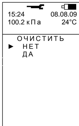
Б.10.4 Кнопками прокрутки выбрать пункт «ДА» и нажать кнопку «
