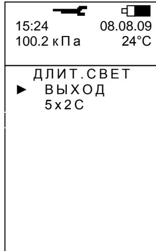
Б.4.3 Для установки временного интервала засветки экрана
