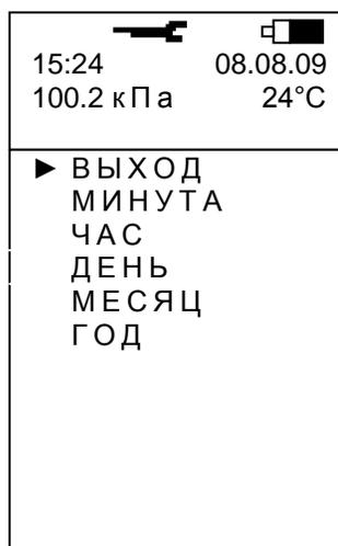
Б.9.4 Кнопками прокрутки выбрать пункт меню, соответствующий устанавливаемому параметру, например, «МИНУТА» и нажать кнопку «
