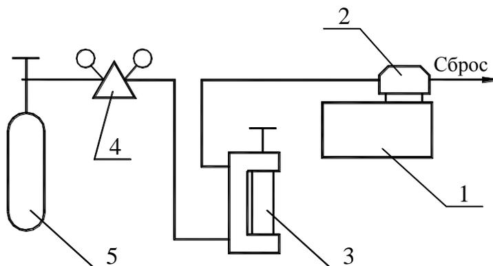
1 – газоанализатор; 2 – насадка АТРВ.305312.002.01; 3 – ротаметр РМ-А-0,063 ГУЗ; 4 - редуктор (регулятор расхода поверочной газовой смеси) ДПК 1,65; 5 - баллон с ПГС
