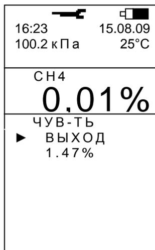
А.6.4 Установить значение объемной доли метана в ПГС используемой для корректировки чувствительности газоанализатора, указанное в паспорте на баллон с ПГС. Для этого
