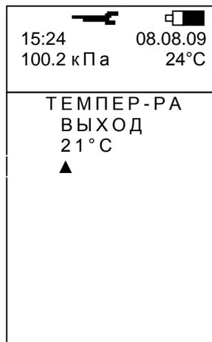
Б.7.4 Для введения поправки в показания температурного датчика установить цифровое значение, равное показанию образцового термометра, для чего:
