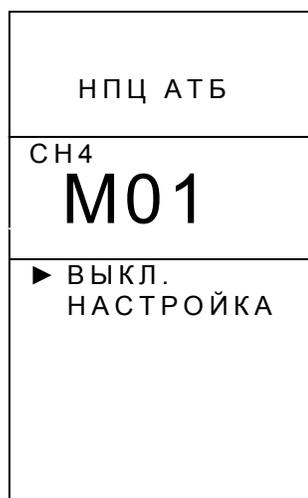
А.4.2 Выбрать в интервал времени 5 с с помощью кнопок прокрутки пункт меню «НАСТРОЙКА» (напротив выбранного пункта меню высвечивается маркер «▶»)
