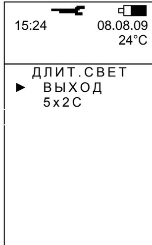
Б.4.3 Для установки временного интервала засветки экрана
