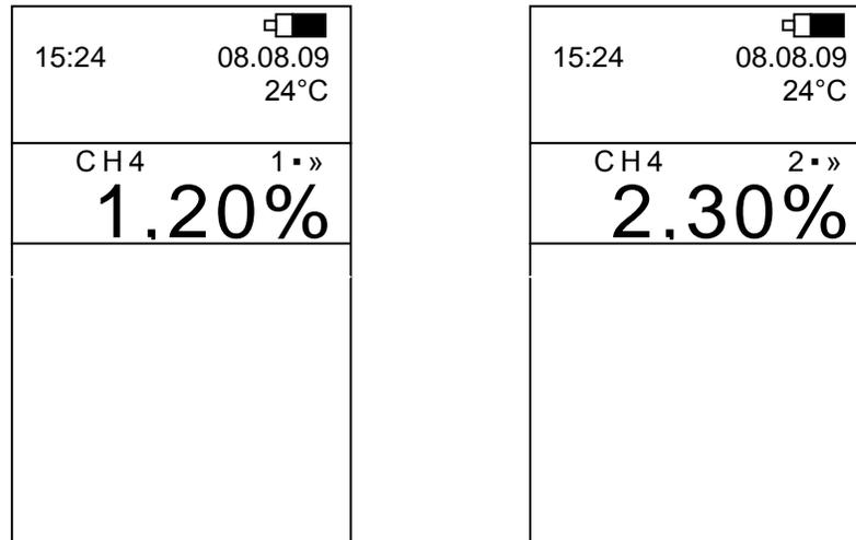
Сигнализацию первого порога (светозвуковая и подсветка экрана) можно отменить нажатием любой из кнопок клавиатуры. При этом в течение всего времени превышения первого порога на экран будет выводиться статически значок первого порога «1▪»», а также текущее значение концентрации метана.
