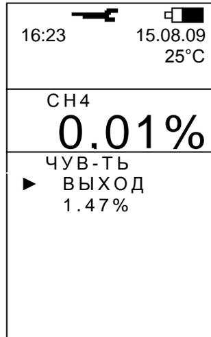
А.6.4 Установить значение объемной доли метана в ПГС используемой для корректировки чувствительности газоанализатора, указанное в паспорте на баллон с ПГС. Для этого
